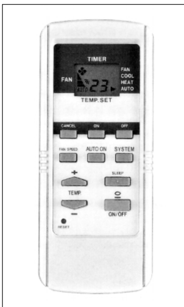
Figura 7. Control remoto por infrarrojos unidad cassette
